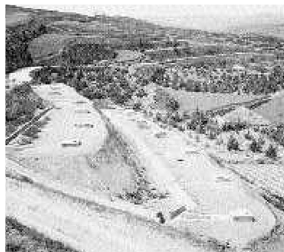
Lorsqu'il pleut, les canaux peuvent drainer l'eau collectée de la route et de la pente de la colline vers les deux rangées de réservoirs. L'eau du réservoir sert à irriguer les cultures et arbres des plaines en contrebas. En bas à droite, la terre est drapée de films en plastique pour éviter l'érosion et augmenter la température du sol. Photo : l'auteur.
